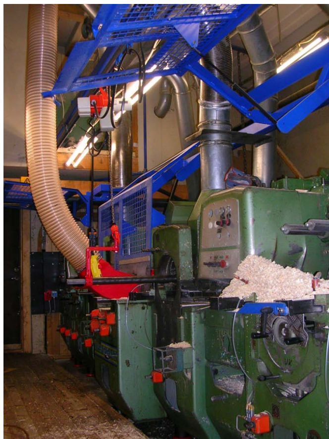
Flerspindlig hyvel med skyddet uppfällt för inställning av hyveln.
