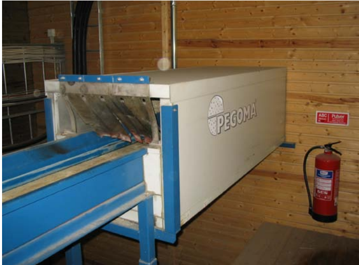
Huv för att minska högfrekvent bullerspridning från hyvelrummet
