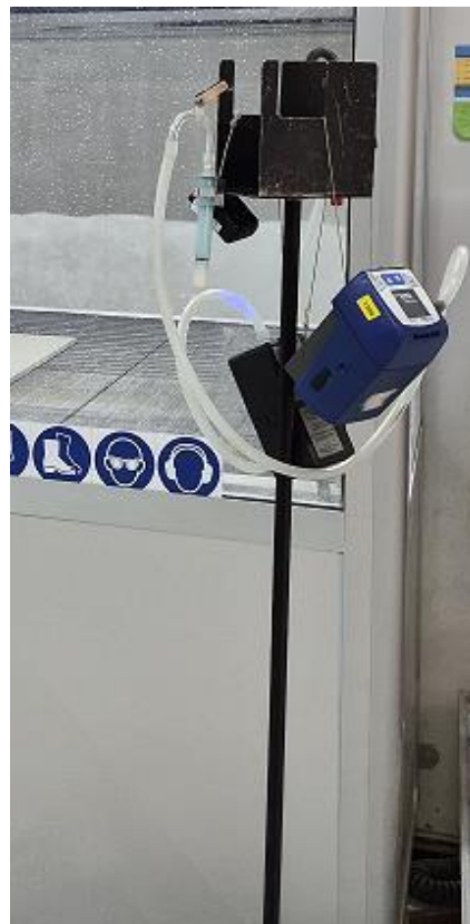
Bild 3. Stationär provplats, stativ med loggande mätning med SidePak respirabel fraktion, AirChek5000 pump, dammfilter med respirabel föravskiljare och Testo 174H
