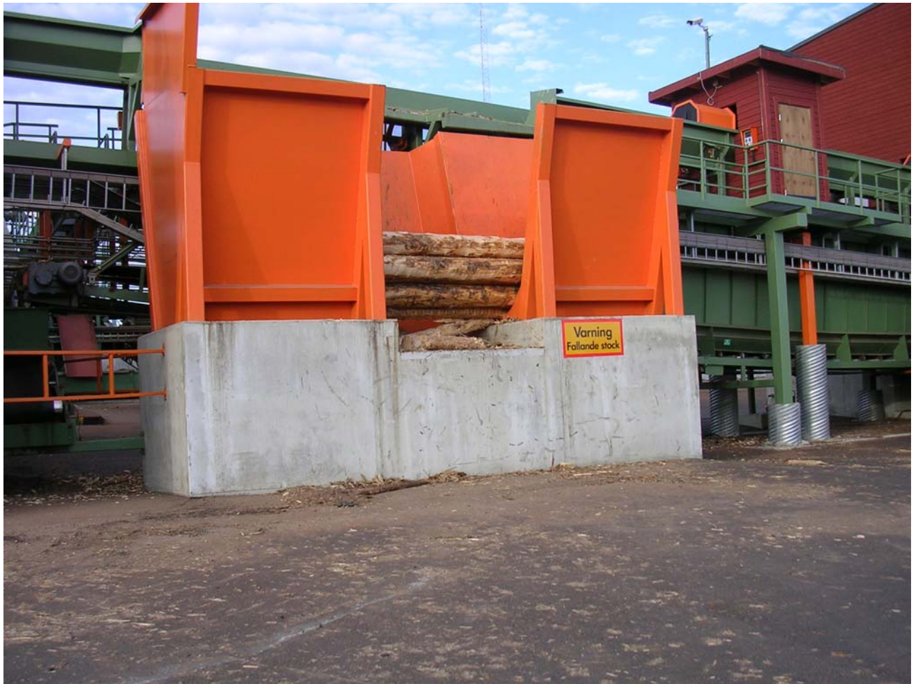
M 1. Fack för utsorterade stockar: Stockar hamnar ibland utanför betongkassunen.
