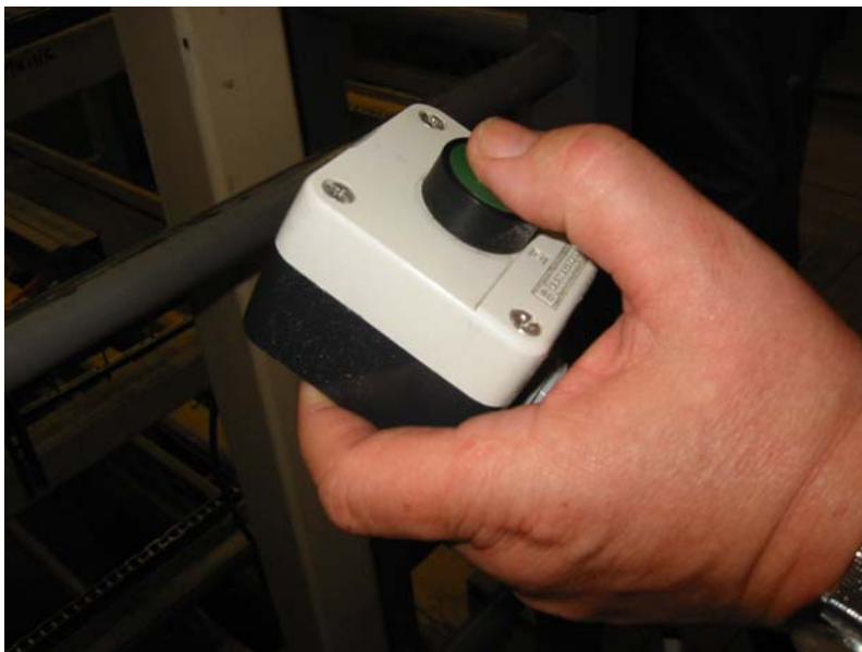
Manuell hantering; manuell utsortering av virke; risk för belastning av hand/fingrar och handled på grund av dålig ergonomisk utformning av manöverdon.
