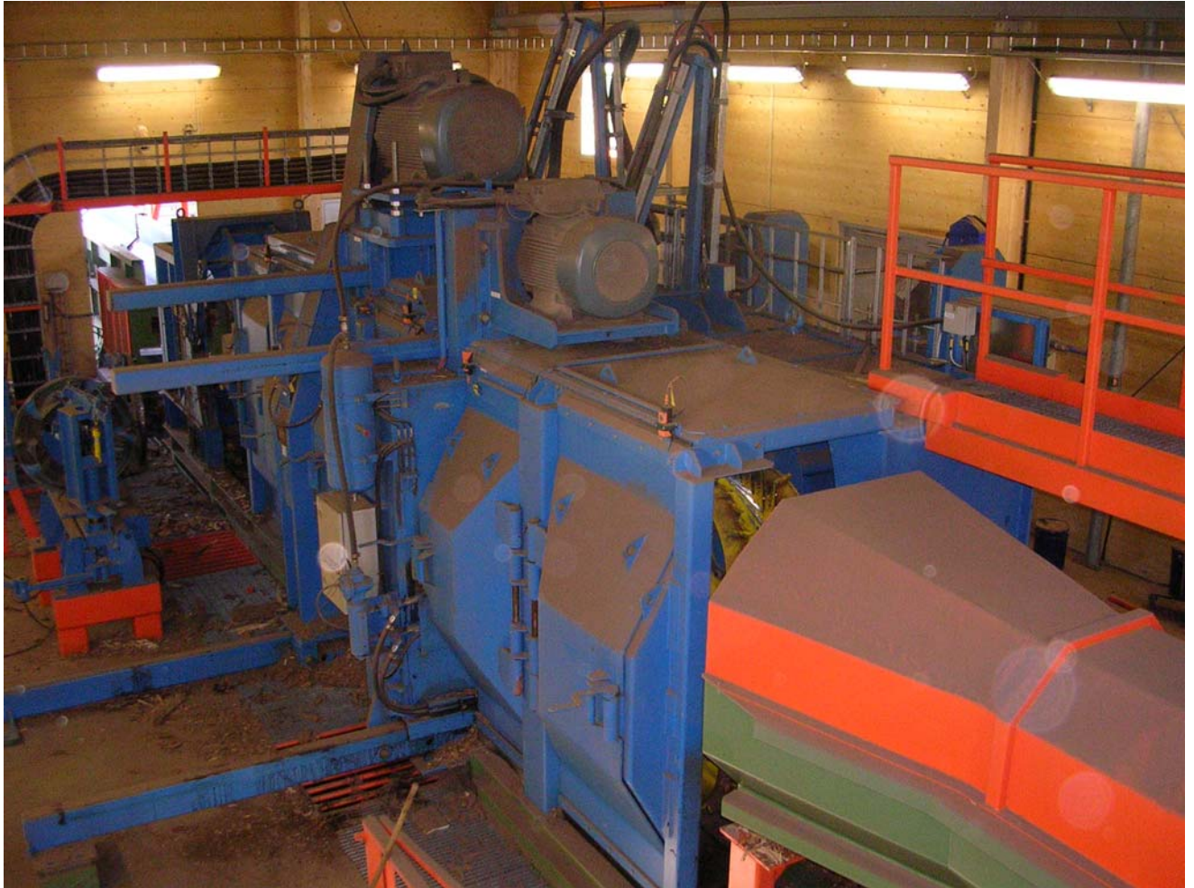
J 2. Barkmaskin: Fallrisk när operatören befinner sig ovanpå barkmaskinen.
