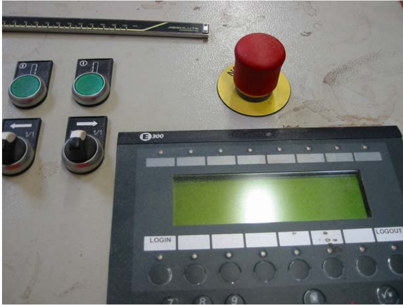
Synergonomi; svårt att läsa av display på pulpet på grund av Infallande reflexer
