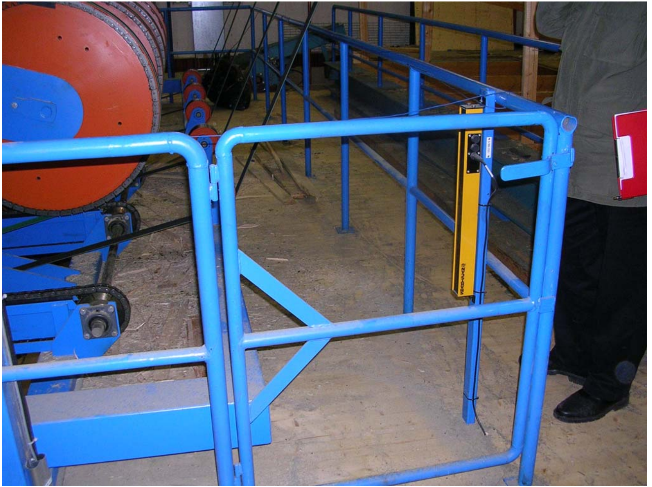
A 12. Vändhjul i råsorteringen: Ljusridå skyddar vid ena sidan men på kortsidan är det enbart tvåledigt räcke som är lätt att krypa igenom.
