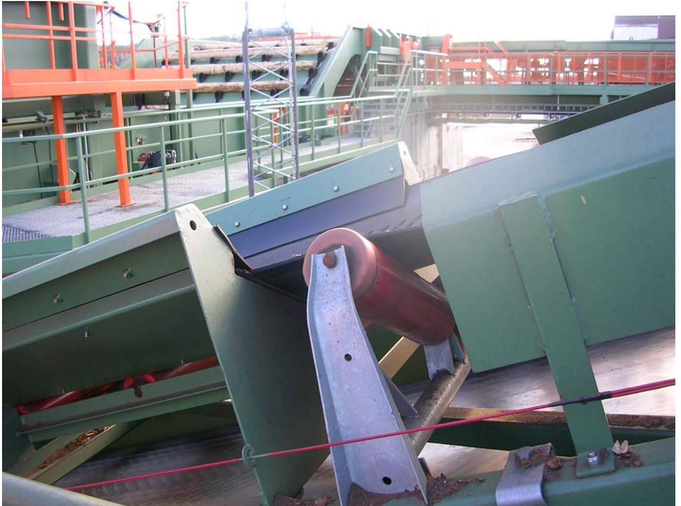
B 2. Barktransportör: Ingreppsrisker vid stödrulle. Enbart nödstoppslina räcker inte.
