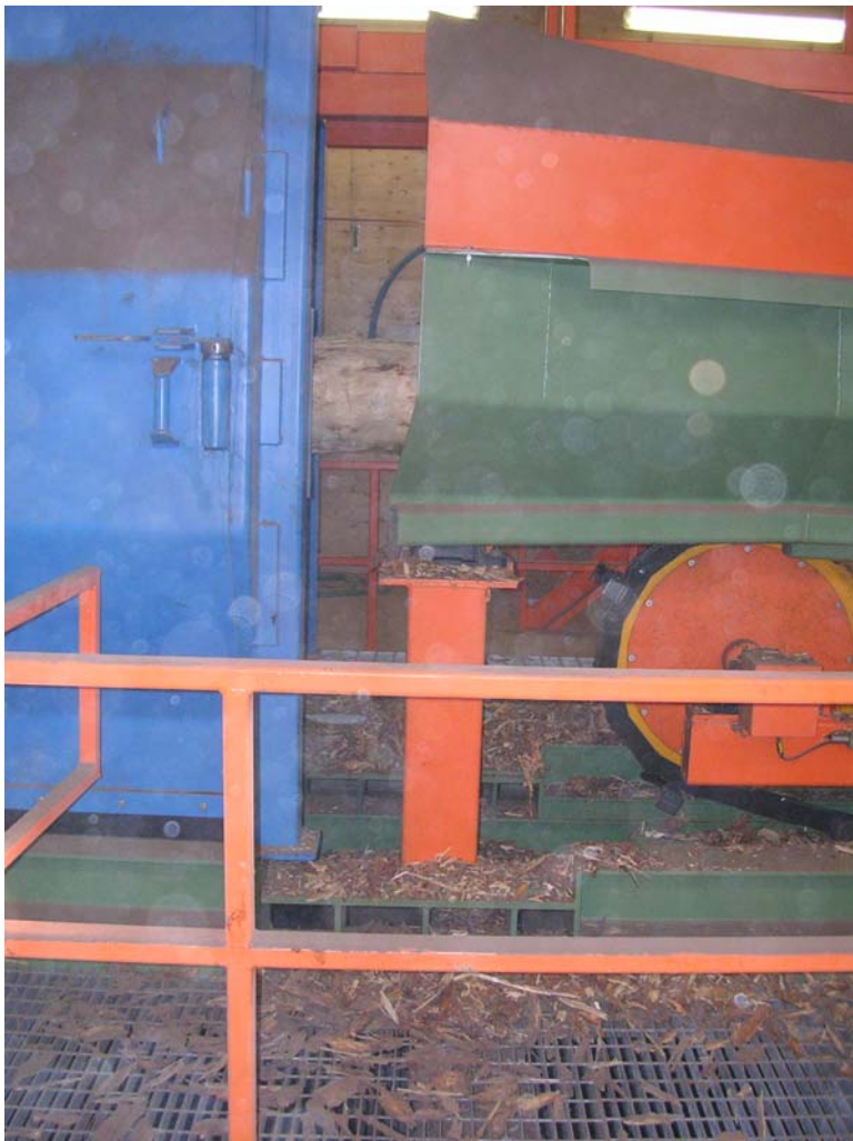
A2. Barkmaskin: Tvåledigt räcke med grind som stod öppen vid besöket. Lätt att krypa igenom grind/staket.
