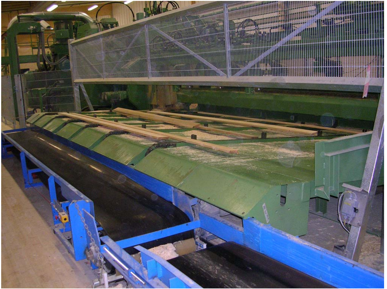
A 11. Såghuset: Lätt att gå på transportörerna och krypa in under staketet som ska skydda mot inpassage till såglinjen.
