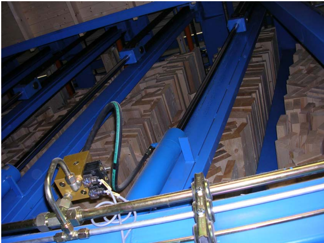
J I. Råsorteringen: Fallrisker när operatören gå upp på facken för att rätta till plankor. Risk för utkast av brädor.
