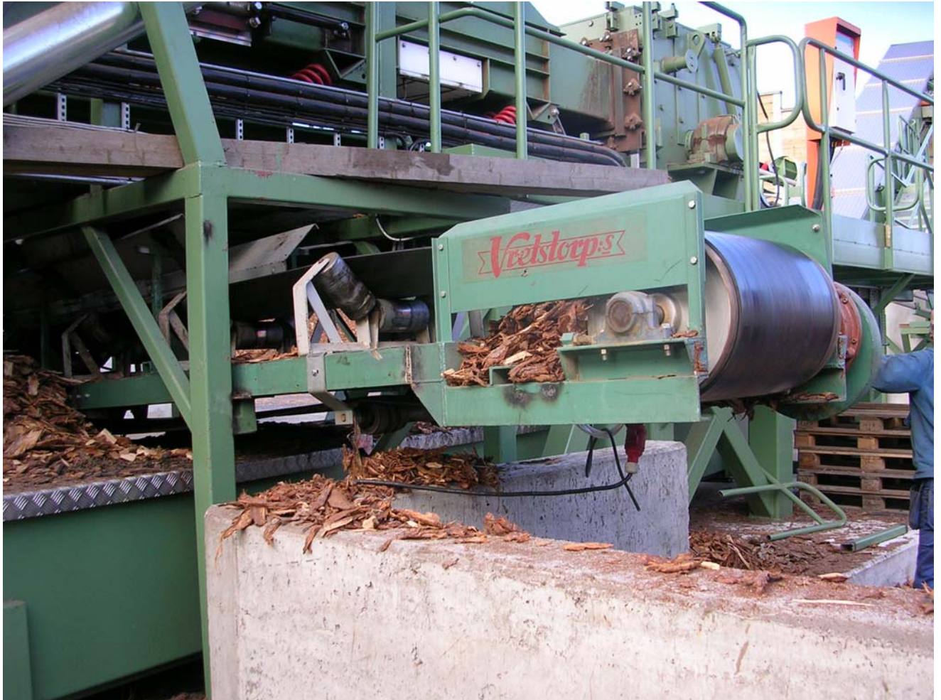
B 3. Transportör för barktransport: Ingreppsrisker vid stödrullar.
