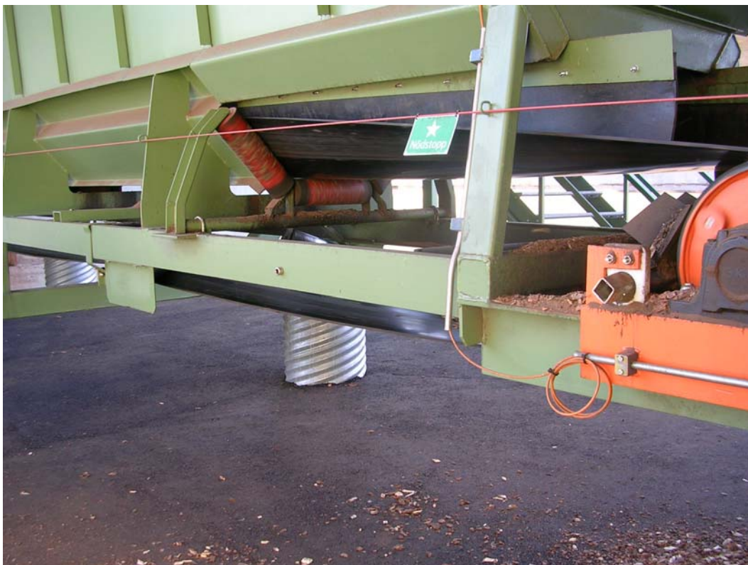
B1. Transportör vid timmerintaget före barkmaskinen: Ingreppet vid stödrullarna och styrrullar saknar skyddsfunktion. Enbart nödstoppslina räcker inte.
