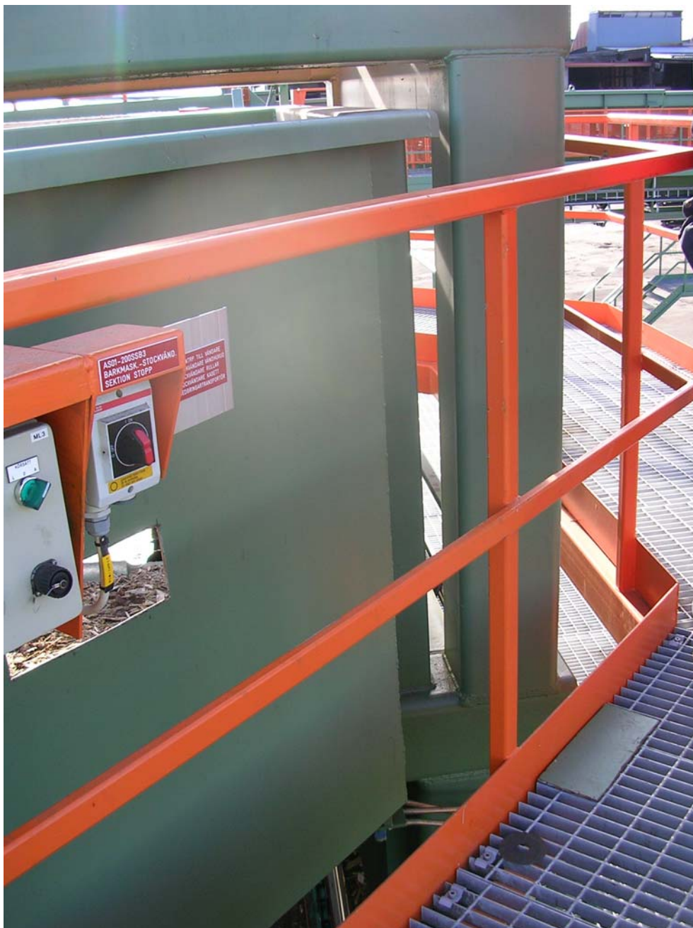
A4. Skydd vid stockvändare: Tvåledigt räcke (1,1 m högt) som är lätt att kliva upp på och ta sig in i stockvändaren. Utkastskyddet är 1,2 m hög. Skyddsbarriären blir därför för låg.
