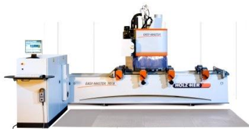
CNC-maskin med PVC-gardiner runt om och verktygshållaren
