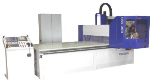
CNC-maskin med PVC-gardiner på sidorna polykarbonat i siktskivan mot operatören
