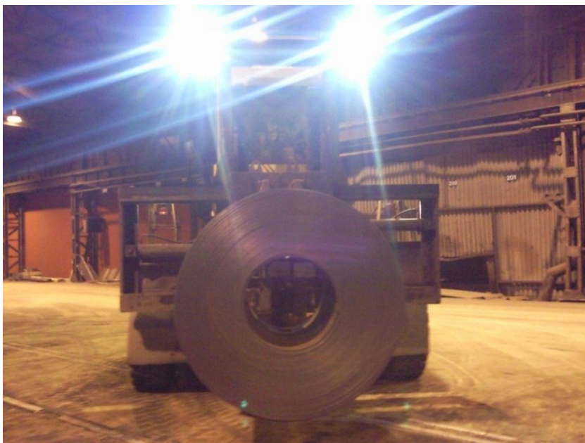
Bild 7. Truck med plåtrulle 23 ton och arbetsbelysningen påslagen. Det påslagna halvljuset syns inte på grund av truckstativet som skymmer.
