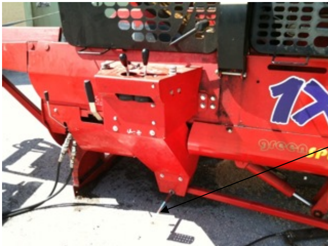
Pedal som operatören trampar ned när stocken ska klyvas. När operatören trampar på pedalen matas stockbiten fram av en stor kolv i maskinen. När huven öppnas går det fortfarande att trycka fram denna kolv. Den går dock inte tillbaka till sitt ursprungsläge förrän huven stängs. Enligt leverantör är just denna maskin då trasig.
