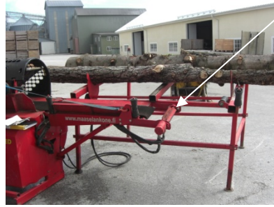
Uppläggningsbord och inmatningstransportör. Pil markerar matarrullen. Bilden tagen från baksidan av maskinen.
