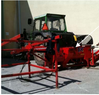
Vedmaskinen drivs via traktor. Pil markerar manöverplats.
