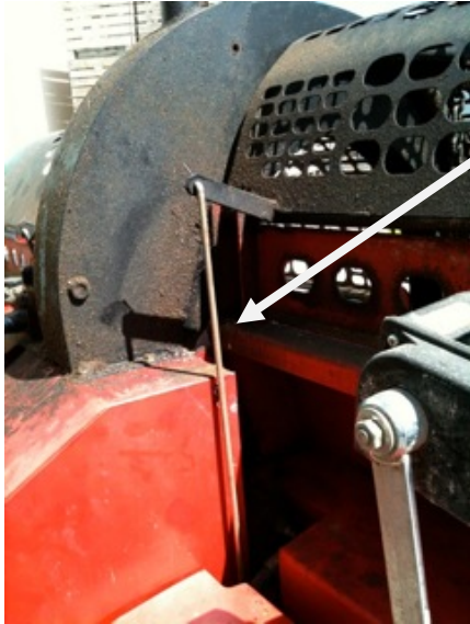
Förreglingsarm på främre svarta huven. Lätt att sätta ur bruk.
