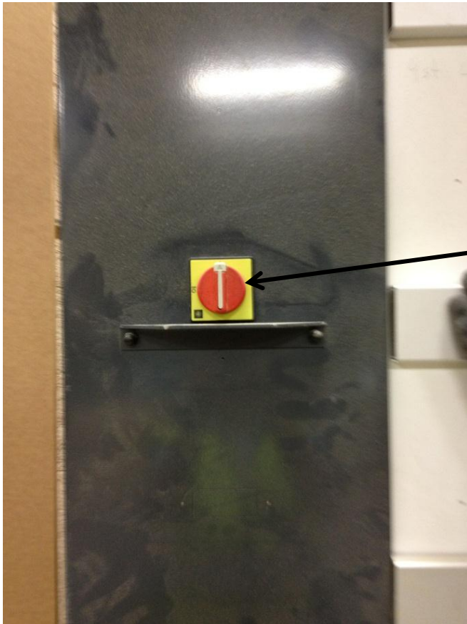
Bild 3. Huvudströmställare på vänster sida av väggsågen. Finns utrymme för hänglås
