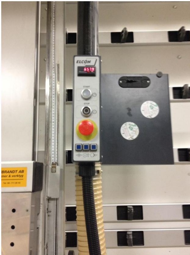
Bild 4. Manöverpanel till väggsågen med tydligt start och stopp.
