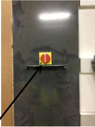
Huvudströmställare på vänster sida av väggsågen. Finns utrymme för hänglås som säkerställer säkert stopp.
