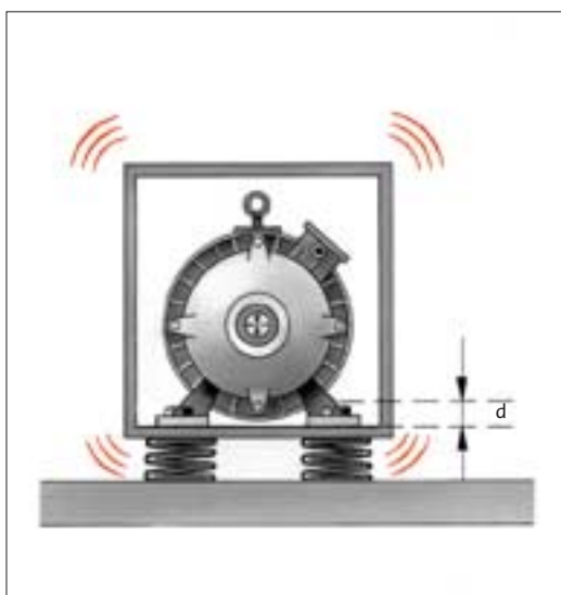
Figur 29. Maskin uppställd på fjädrande element
