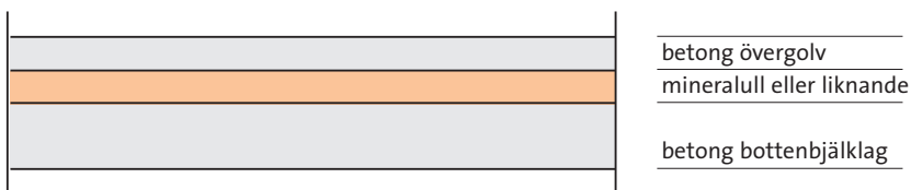
Princip för flytande golvkonstruktion
