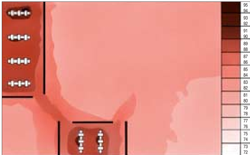
Figur 24. Beräknade ljudnivåer för produktionslokal (50 · 35 · 4 meter) med absorptionsfaktorn 0,2 hos tak och väggar samt skärmar runt de bullrande maskinerna
