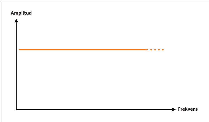
Figur 5a+b. Brus från en helt slumpmässig process exempelvis ett vattenfall ger upphov till ett så kallat kontinuerligt ljudspektrum utan enskilda frekvenskomponenter
