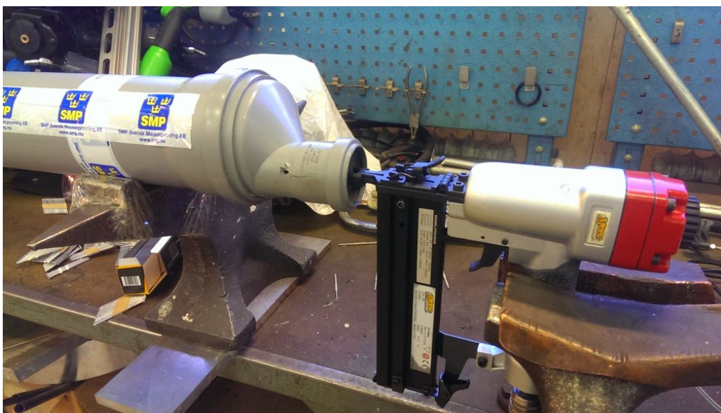
Figur 2. Testrigg för test av avfyrningskraft.
