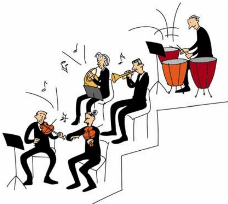
Figur 8.5 Placering av musikerna på podier gör att ljudet kan utbreda sig mer obehindrat och inte strålar direkt in i framförvarande musiker. Blåsarna kan då spela svagare utan att ljudnivån hos dirigent och åhörare minskar.
