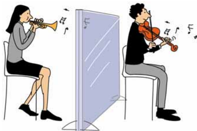
Figur 8.7 Genom att använda ljudabsorberande transparenta skärmar kan exponeringen från ljudstarka instrument minskas i konsertsalen.
