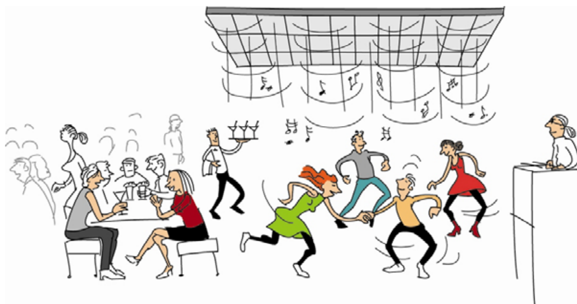
Figur 11.3 Med ljudtak kan ljudet koncentreras mot dansgolvet och ljudnivån begränsas i övriga delar av lokalen.
