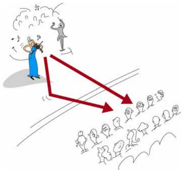
Figur 8.6 En tom golvyta längst fram på orkesterpodiet hjälper till att förstärka ljudet från stråkarna så att violinisterna inte behöver spela så starkt för att nå ut i salen.
