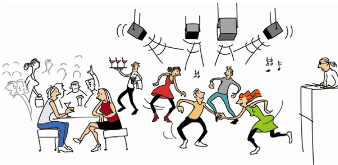
Figur 11.2 Med flera högtalare riktade snett nedåt och inåt får man en jämn fördelning av ljudet som koncentreras mot dansgolvet.
