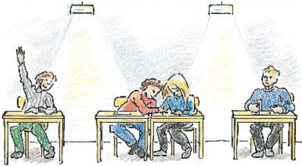
Fig 9 Placera direktverkande armaturer vid sidan av bänkarna, eftersom den största kontrastreduktionen normalt är rakt under armaturen.
