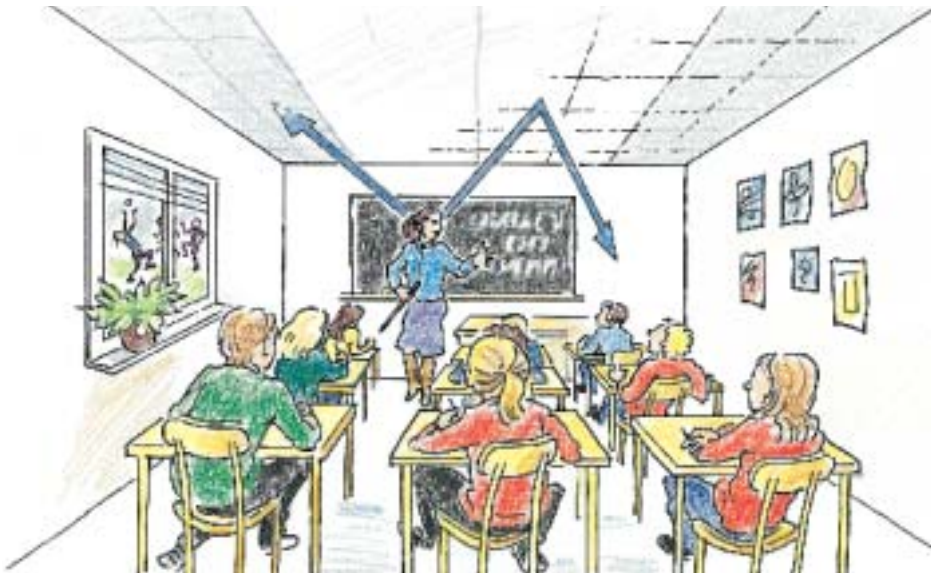
Fig. 5 Exempel på placering av absorbenter i tak.
