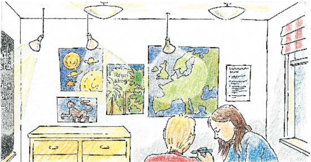
Fig 11 Att belysa väggar och tak, är ett effektivt sätt att med relativt begränsad ljusmängd ge känsla av ett ljust rum. En medveten fördelning av ljuset i rummet är grunden för goda synförhållanden. Viss runtomspredning av ljuset är normalt en fördel. Använd väl avskärmad armatur med "normal" ljusdistribution. Avancerad reflektorteknik och effektivitet ställer krav på mer stationära arbetsplatser än vad som normalt förekommer i skolsalar. Avancerad reflektorteknik ökar också risken för bländning, om armaturen placeras fel.
