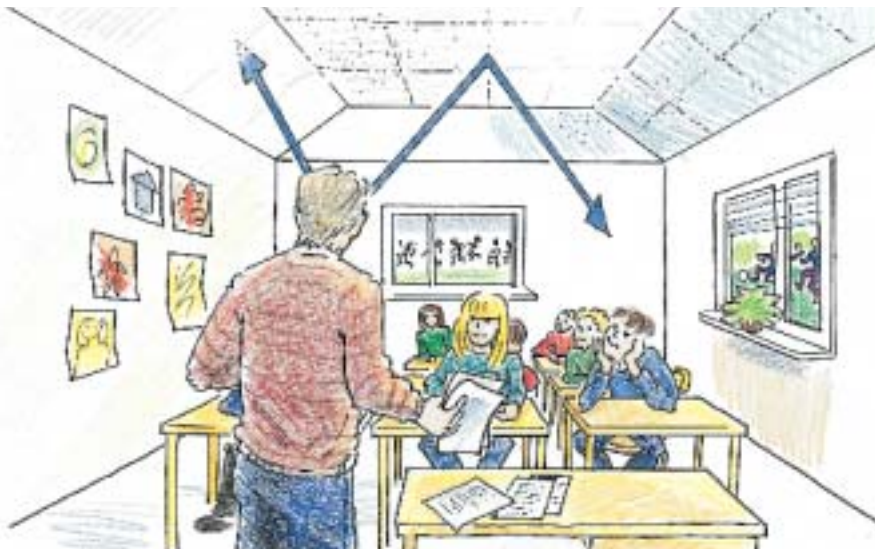
Fig. 6 Exempel på montage av diagonalabsorbenter.
