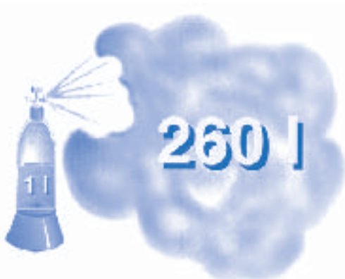
Bild 2.4 Redan små mängder brännbar vätska kan vid förångning bilda stora mängder brännbara ångor (exempelvis flytande propan).
