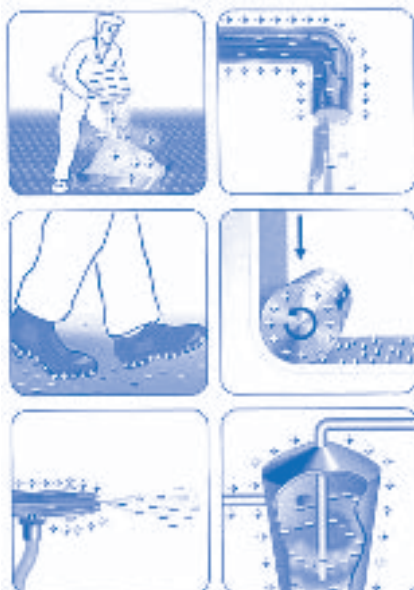
Bild 3.6 Exempel på laddningsseparationer som kan ge upphov till elektrostatisk uppladdning 11
