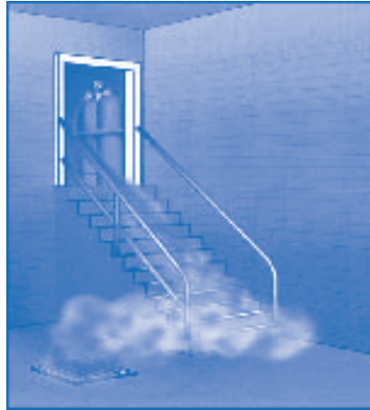
Bild 2.3 Utbredningsmönster för gaser som övergått i flytande form (exempel) 6
